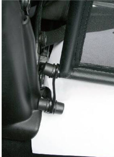
Bild 8 Mitgelieferte Abdeckkappen auf Schrauben stecken!
